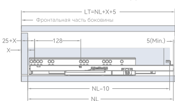
МОНТАЖ НАПРАВЛЯЮЩИХ С ВНУТРЕННИМ ФАСАДОМ
